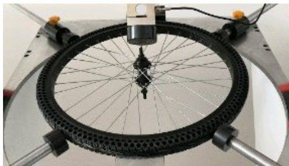
图 5 某公司的轮胎脱圈试验方法
