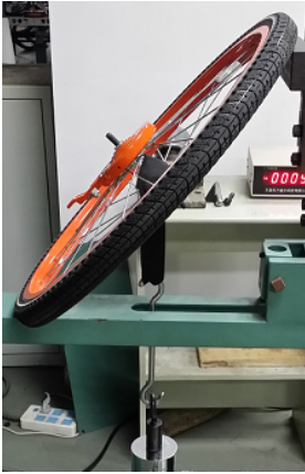
图6 倾斜脱圈的试验方法
