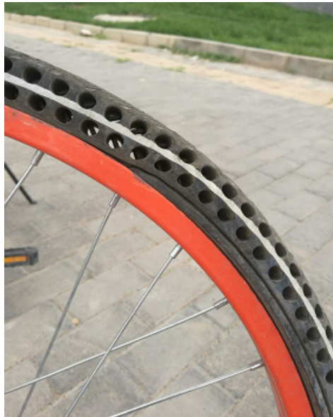
图 3 市场上免充气轮胎脱圈
